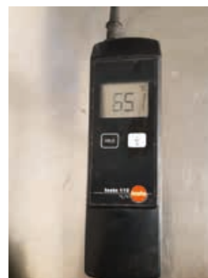
Abb. 1: Messung des Luftdurchflusses an A1 im Automatischen Melksystem. Abb. 2: Messung des Vakuum an Vm im Automatischen Melksystem. Abb. 3: Messung Leitfähigkeit zur Bestimmung der Konzentration der Reinigungslösung. Abb. 4: Temperaturmessung Melkanlagenspülung
