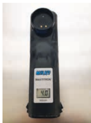
Abb. 1: Messung des Luftdurchflusses an A1 im Automatischen Melksystem. Abb. 2: Messung des Vakuum an Vm im Automatischen Melksystem. Abb. 3: Messung Leitfähigkeit zur Bestimmung der Konzentration der Reinigungslösung. Abb. 4: Temperaturmessung Melkanlagenspülung
