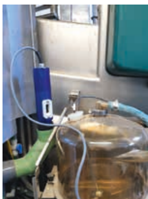
Abb. 1: Messung des Luftdurchflusses an A1 im Automatischen Melksystem. Abb. 2: Messung des Vakuum an Vm im Automatischen Melksystem. Abb. 3: Messung Leitfähigkeit zur Bestimmung der Konzentration der Reinigungslösung. Abb. 4: Temperaturmessung Melkanlagenspülung
