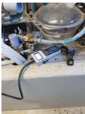
Abb. 1: Messung des Luftdurchflusses an A1 im Automatischen Melksystem. Abb. 2: Messung des Vakuum an Vm im Automatischen Melksystem. Abb. 3: Messung Leitfähigkeit zur Bestimmung der Konzentration der Reinigungslösung. Abb. 4: Temperaturmessung Melkanlagenspülung
